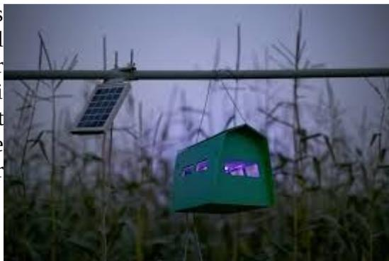
D'autres analysent le son comme Captrap développé par Cap 2020. C'est un piège connecté pour la détection automatisée et intelligente de la noctuelle - ravageur de la tomate. Le piège analyse le mouvement et la signature sonore de la noctuelle pour la compter intelligemment. Les comptages sont envoyés en temps réel sur une interface en ligne. Le gestionnaire du réseau de pièges peut alors consulter l'ensemble de ses pièges et gérer les alertes.
