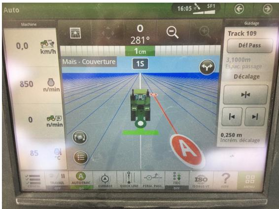
Le chauffeur mémorise une ligne droite A -B ; un boîtier en cabine, couplé avec un terminal GPS, vient piloter une électrovanne, branchée sur le circuit hydraulique de variation de la largeur de travail de la charrue. Un potentiomètre fixé sur la charrue informe de la largeur. Avant la première utilisation, le nombre de corps, la distance entre les corps et les largeurs de travail minimales et maximales sont entrées dans le boîtier – antenne GPS – signal RTK
