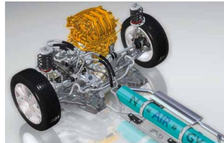
Chaîne de traction HYbrid Air, PSA
