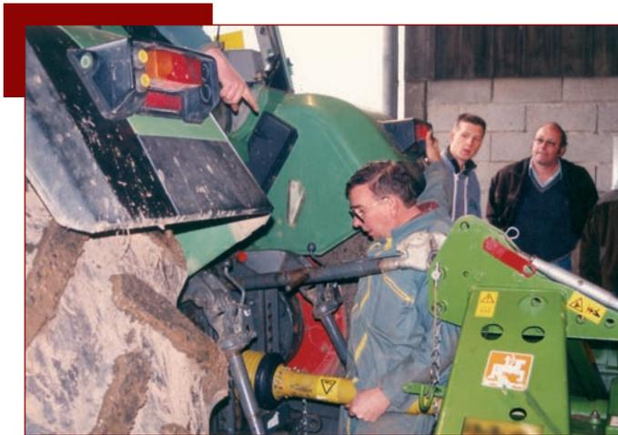
L'opérateur peut actionner les commandes du relevage tout en se situant dans la zone à risques.
