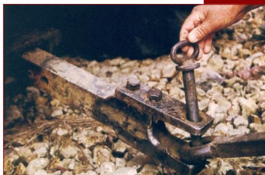
**Les dimensions et les différences de niveaux entre l'anneau d'attelage et la barre oscillante ne permettent pas le passage de la broche pour réaliser l'attelage souhaité.**
