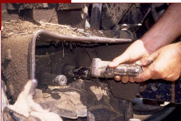
Utilisation d'un adaptateur de prise de force pour connecter l'arbre à cardans.
