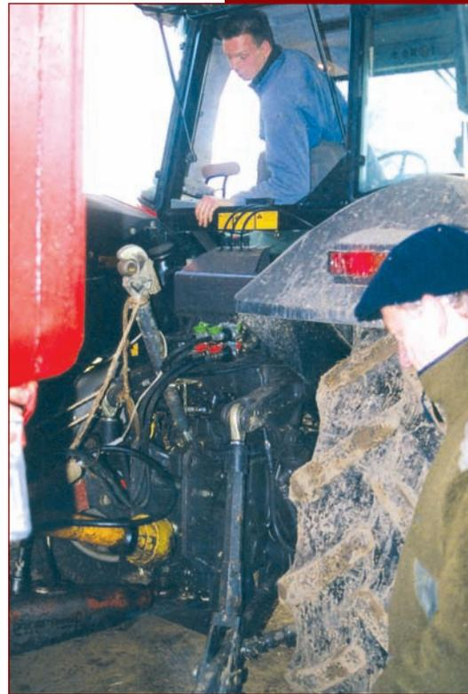
Attelage d'une benne à l'arrière du tracteur imposant à l'opérateur une posture dangereuse (pied sur la pédale d'embrayage).
