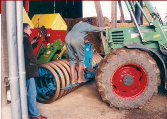
Pour réaliser la connexion des bras inférieurs du relevage sur l'outil, l'opérateur au sol utilise son propre poids.
