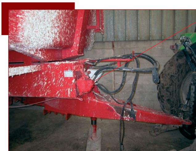
**Benne agricole animée par une pompe hydraulique.**
