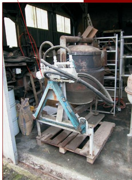
**Bétonnière entraînée par un circuit hydraulique relié au tracteur.**
