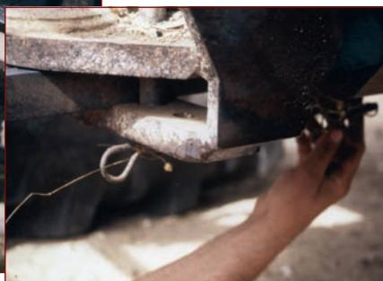
La barre oscillante a l'avantage de se déplacer latéralement, permettant un déport latéral qui peut être utile pour certaines machines. Les masses en jeu, la hauteur, la stabilité relative du matériel dételé sont à l'origine des principales contraintes rencontrées par l'opérateur.
