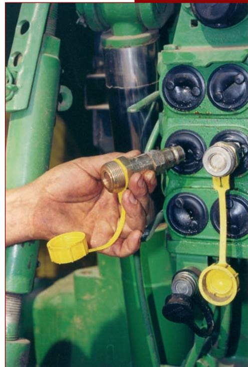
Nécessité d'un connecteur push-pull vissant pour connecter une prise hydraulique.
