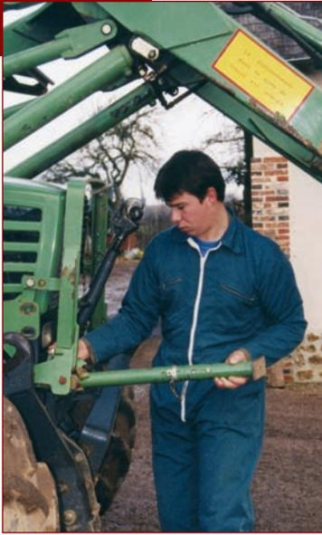
Il est nécessaire de manipuler les béquilles de stabilisation sur le chargeur « dételé » :
