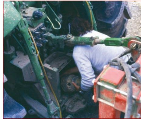
Le peu d'espace libre entre les éléments protecteurs rend la connexion difficile. Si le système de verrouillage de l'arbre à cardans sur la prise de force nécessite d'utiliser les deux mains, cette opération est encore plus compliquée.
