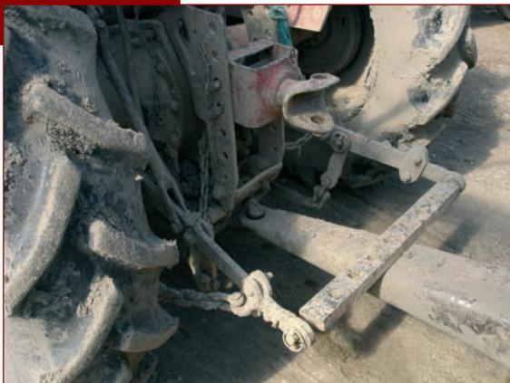
**Benne attelée au crochet ramasseur.**
