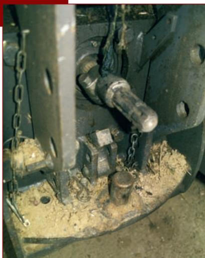
**L'espace libre entre le piton et la prise de force est parfois trop faible, d'où une dégradation de la protection de l'arbre à cardans qui peut être importante.**
