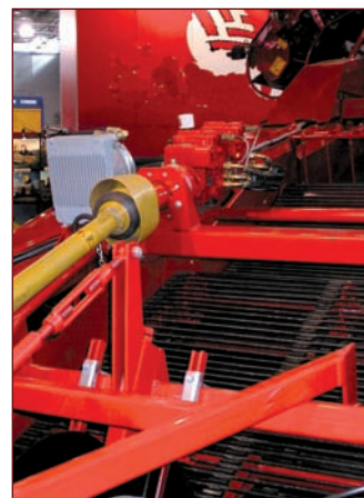
Entraînement d'une pompe hydraulique.
