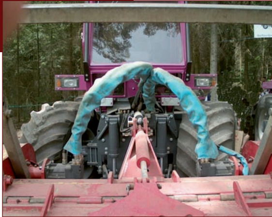
Exemple d'installation hydraulique directe.
