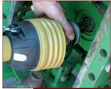
Mise en place de l’arbre à cardans sur la prise de force.
