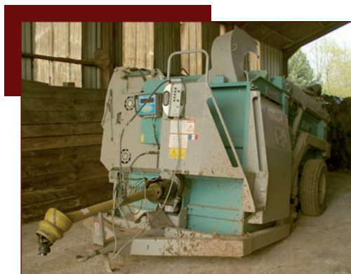
Boîtier de commande et nombreux flexibles situés à proximité de l'arbre à cardans.
