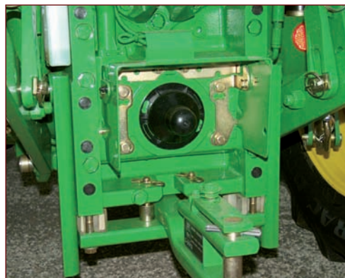
Prise de force protégée par un bouclier.
