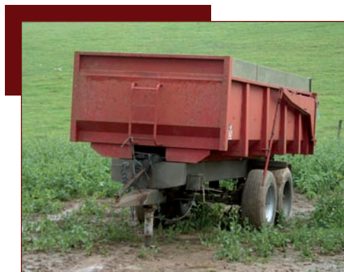
Échelle de visite nécessitant d'enjamber un arbre à cardans non protégé.
