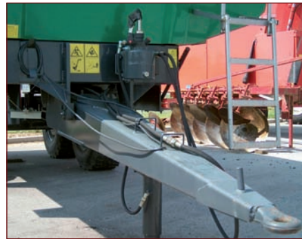
Utilisation de l'hydraulique pour le relevage.
