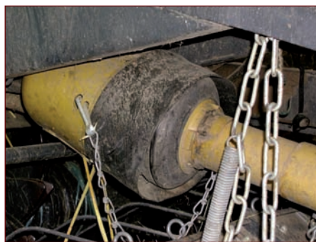
Fixation de la chaînette sur un anneau en plastique intégré au bol.
