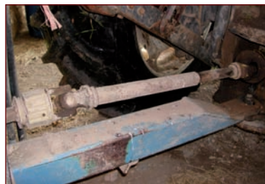
Absence de l'ensemble des éléments du protecteur.
