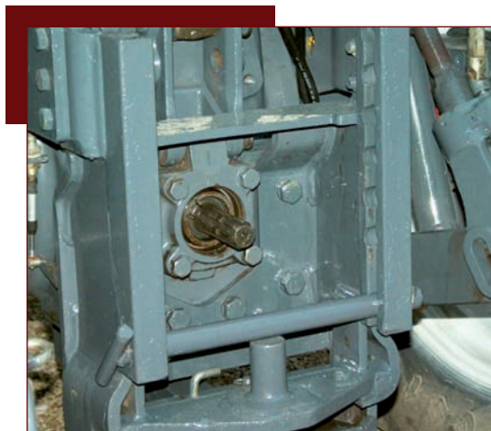
Prise de force classique à 6 cannelures, protégée par une échelle de chape.
