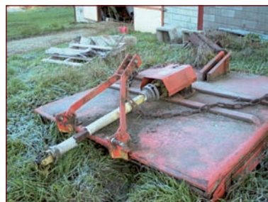
Tubes usés en raison des frottements sur le bâti de la machine.
