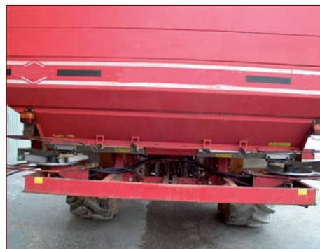
Un distributeur à engrais à plateaux entraînés par l'hydraulique.
