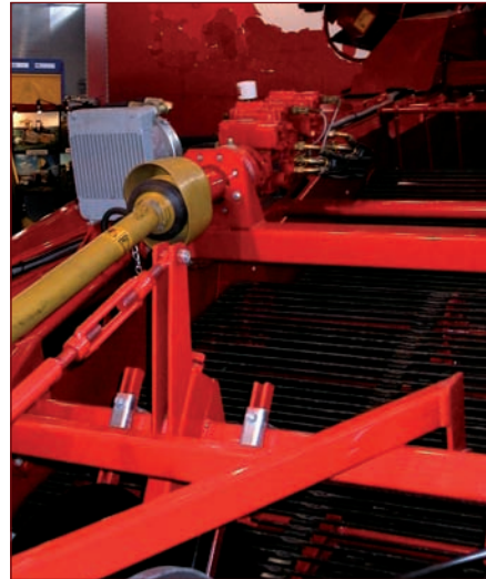
Utilisation d'un arbre à cardans pour animer une pompe hydraulique sur l'outil.
