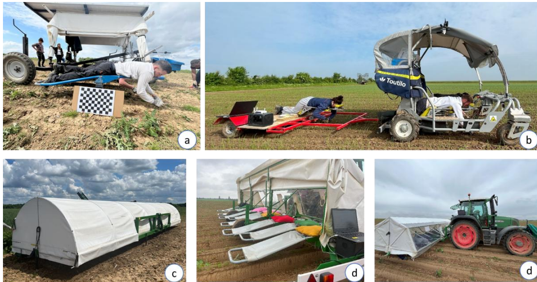
Figure 5 Exemples de lits de travail à traction électrique (a et b) ou thermique (c, d et e)
