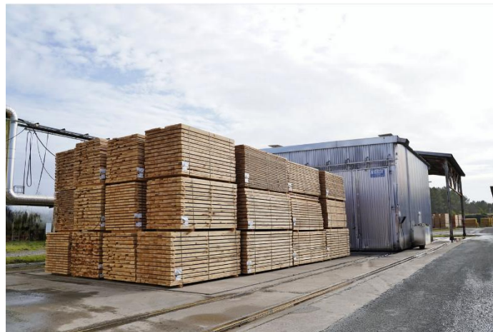
Une chambre chauffante sur rail se déplace sur les sciages pour leur faire subir un traitement thermique assurant la destruction du nématode et de son vecteur.
