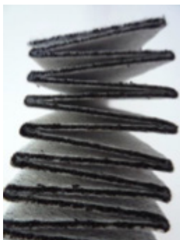
Filtre plissé avec 1 à 2 mm d'épaisseur de charbon conformité suspectieuse
