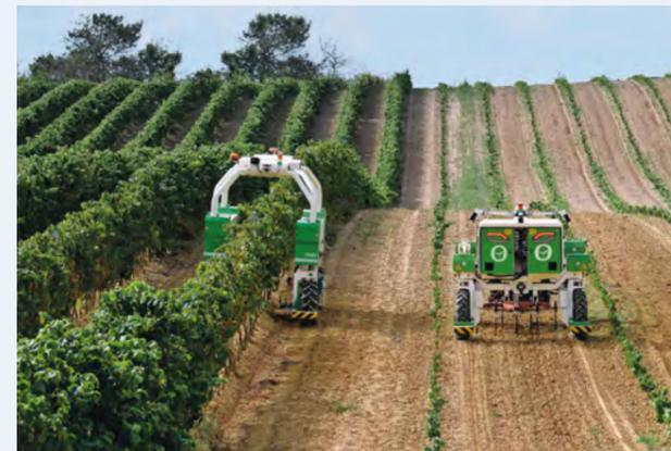
À gauche, le robot enjambeur TED permet de désherber entre les rangs et sous le rang ; à droite le robot Orio, assure le binage et le désherbage dans les rangées de cultures. Ces robots, de la société Naïo, sont autonomes et ne nécessitent pas de supervision.
