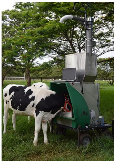
Figure 9 : Mesure du méthane avec le système GreenFeed® - INRAe
