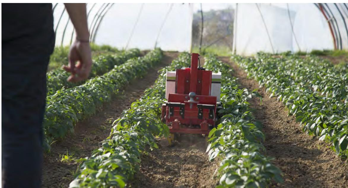
Robot de désherbage mécanique automatisé pour le maraîchage
