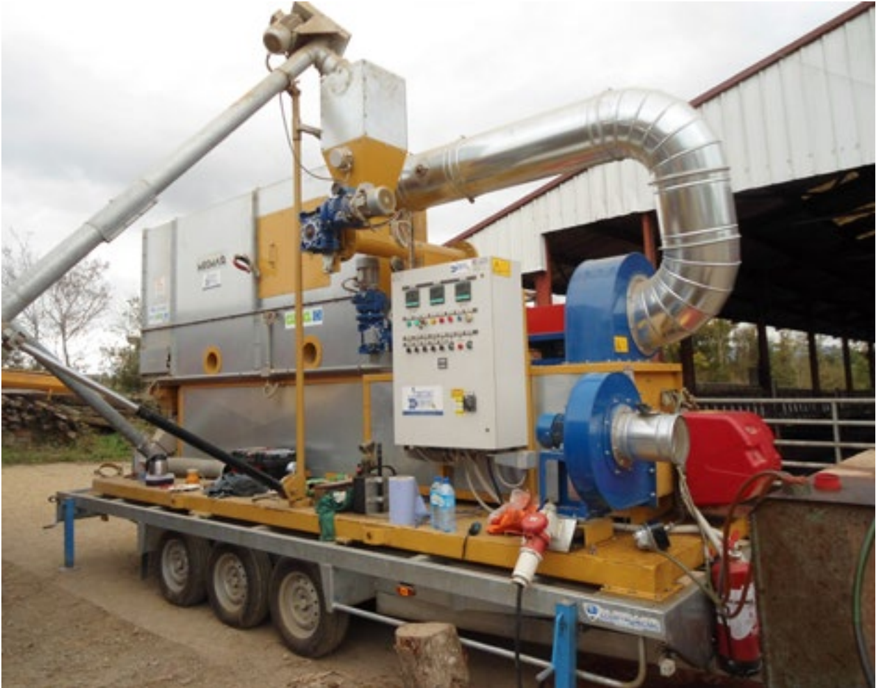
En 2019, ce toaster a tourné 740 heures, à raison de deux tonnes de graines de soja/h ©FDCuma 640
