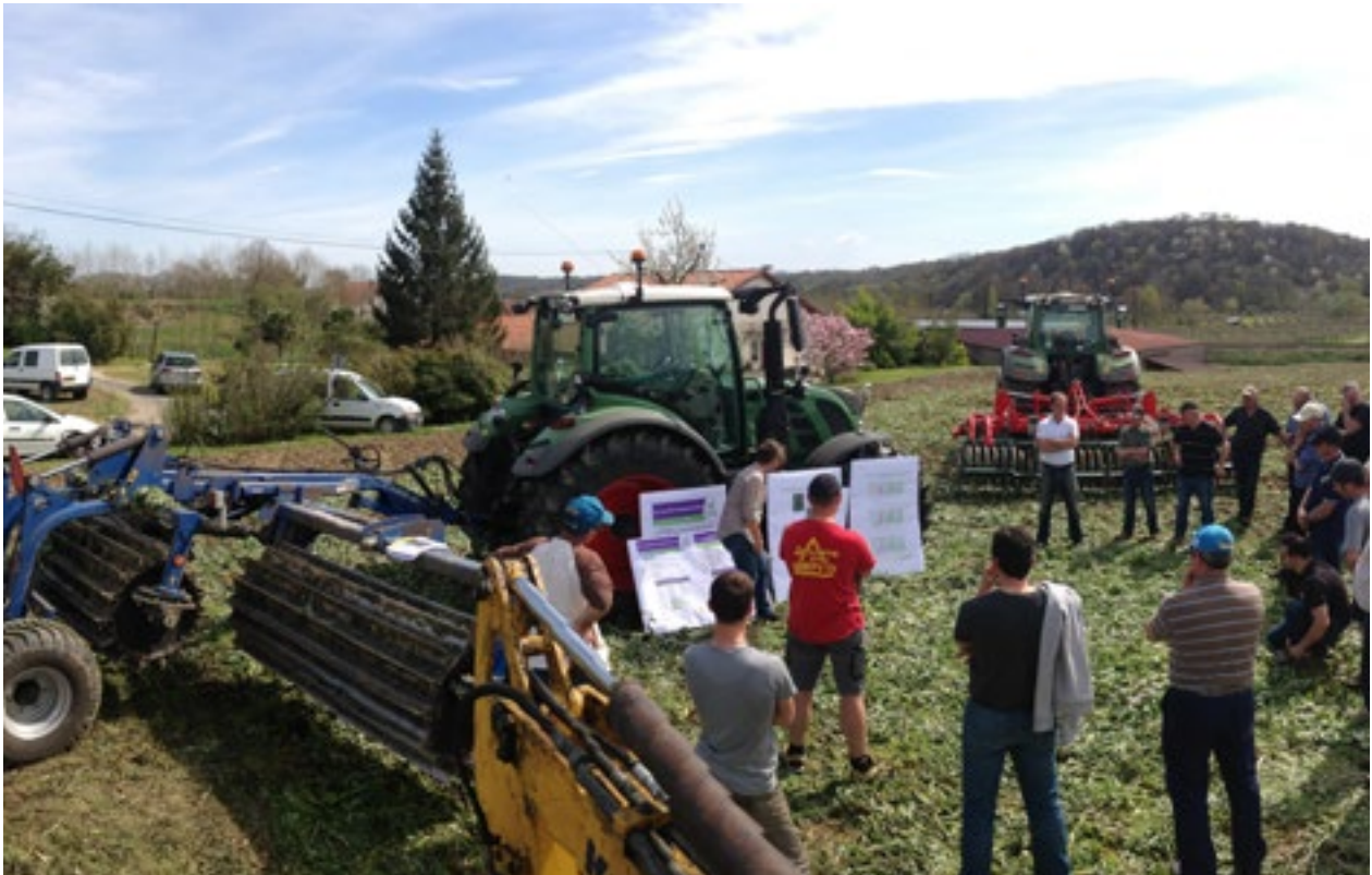
Démonstration de destruction mécanique des couverts végétaux par des rouleaux écraseurs type Faca © FDCuma 640
