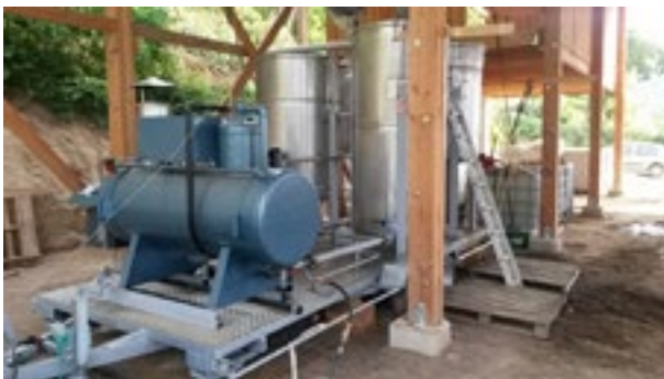
La Papamobile, outil de distillation mobile des plantes à parfum, aromatiques et médicinales © Agribio 04
