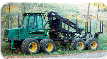
Abatteuse avec porteur © Wikipédia
