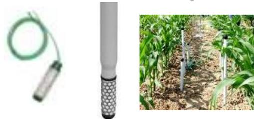
La tensiométrie : mesure au champ de la tension de l'eau du sol
