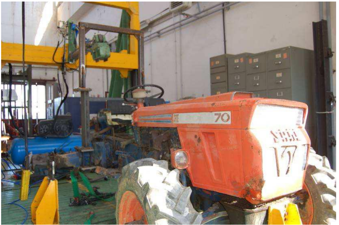
Figure 10 – Structure de protection pour tracteur à roues à voie standard SAME LEONE 70
