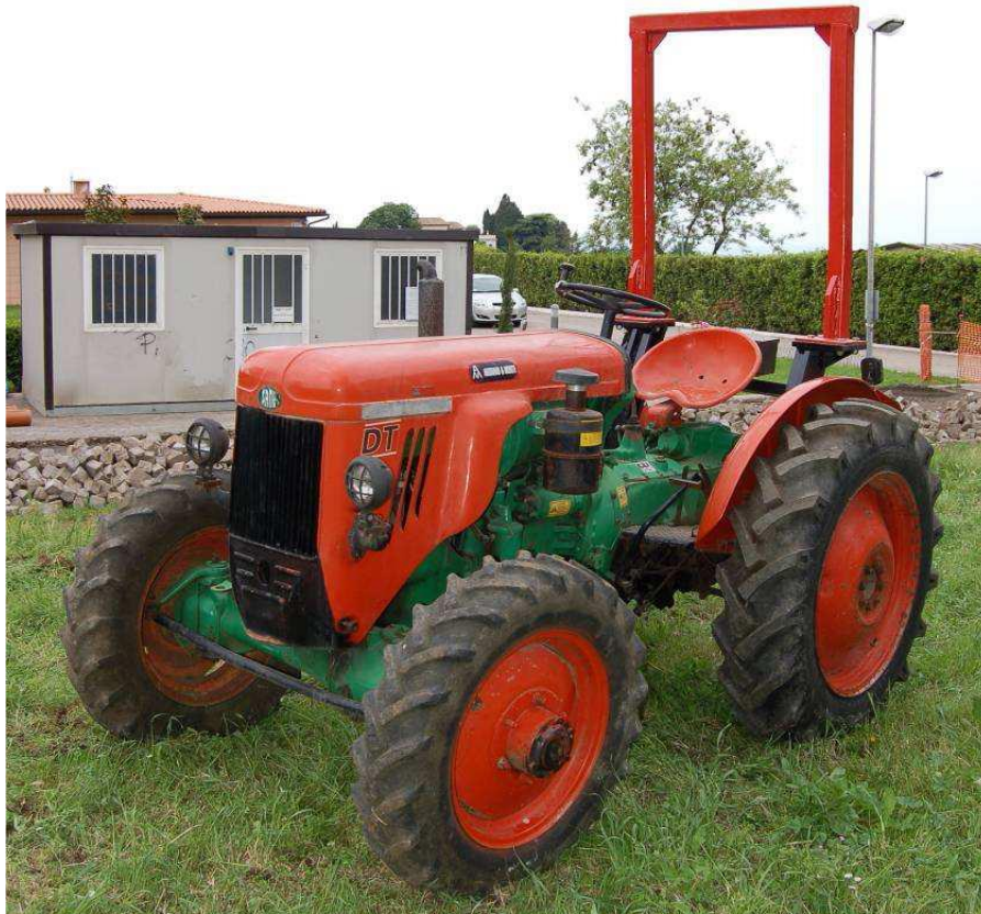
Figure 11 – Structure de protection pour tracteur à roues à voie standard Same D.A. 30
