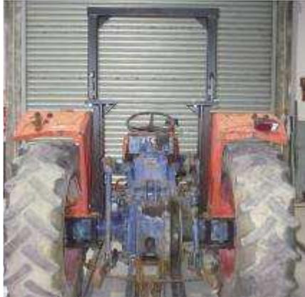
Figure 12. Structure de protection de type arceau arrière destiné à un tracteur à roue à voie standard de type Same Corsaro 70.
