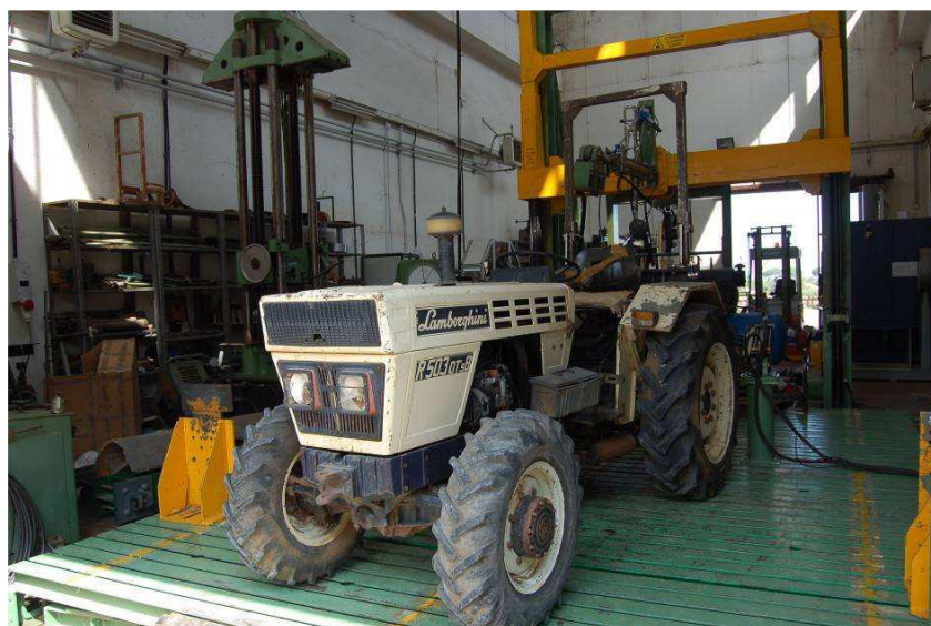
Figure 13 – Structure de protection pour tracteur à roues à voie étroite Lamborghini R503 sB et similaire
