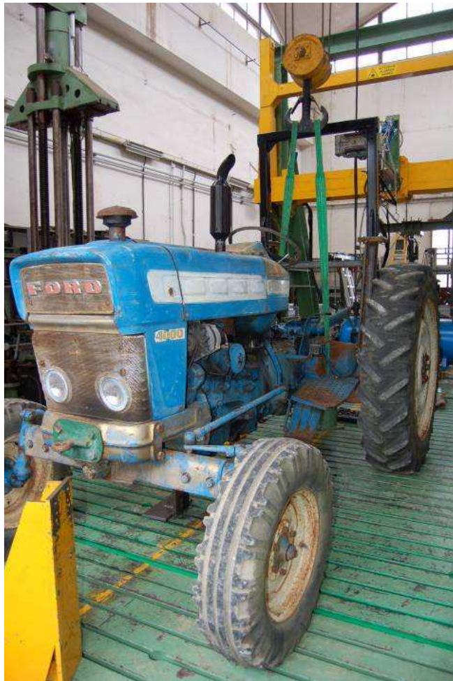
Figure 11 – Structure de protection pour tracteur à roues à voie standard FORD MAJOR 4000
