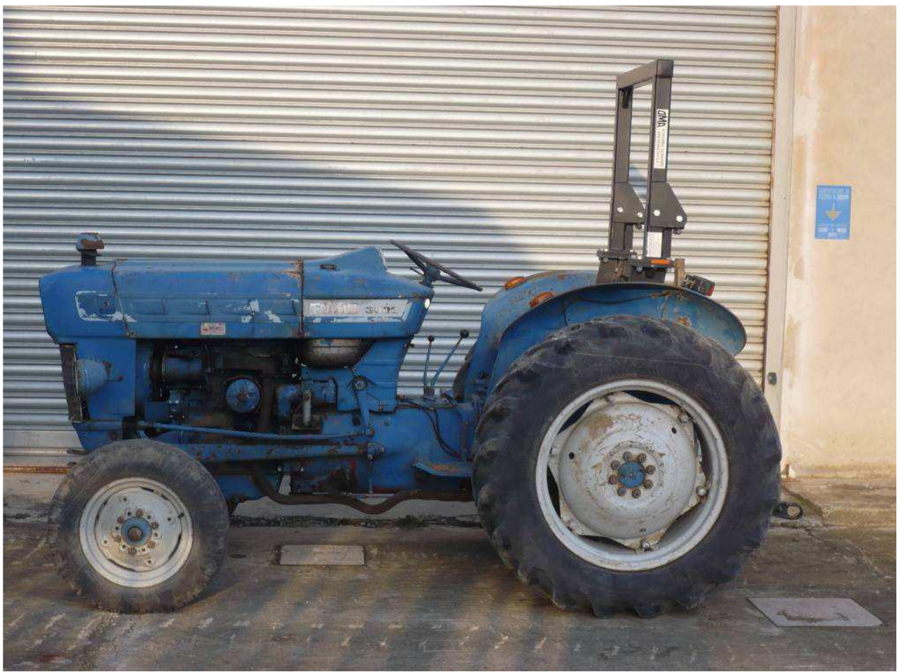
Figure 10. Structure de protection de type arceau arrière destiné à un tracteur à roue à voie standard de type FORD SUPER DEXTA 3000.
