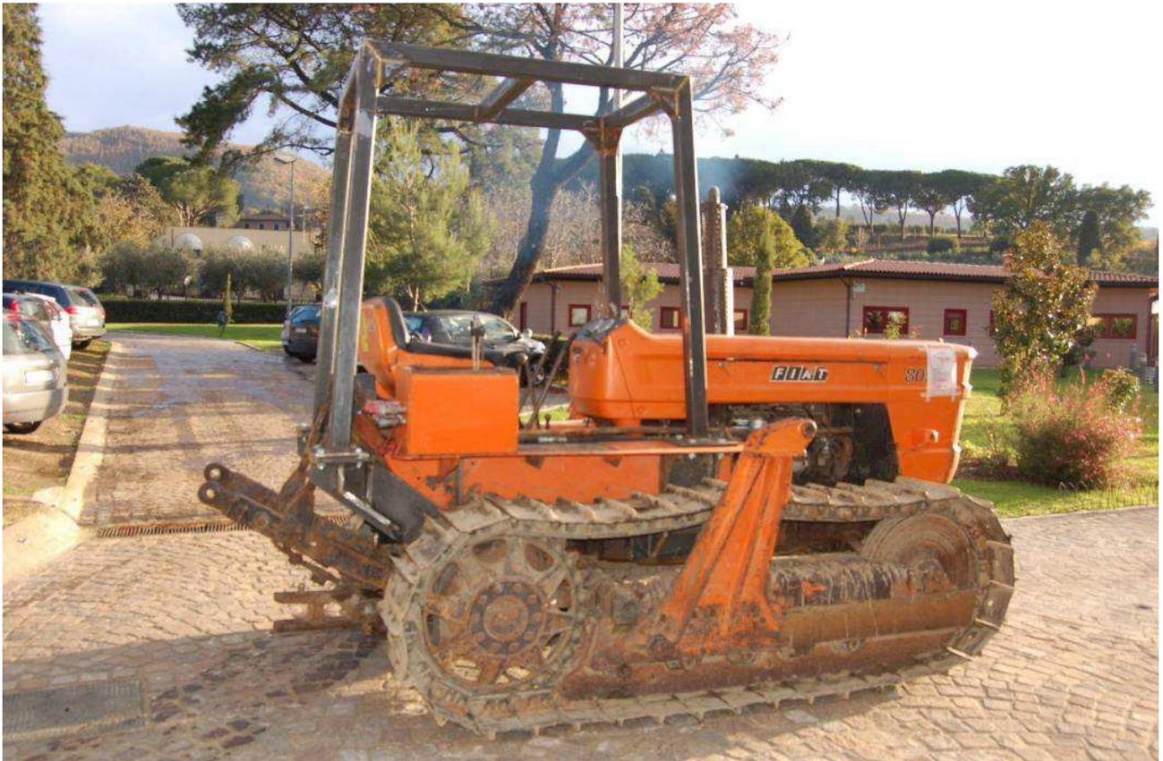
Figure 19 – Structure de protection pour tracteur à chenilles FIAT 805 C
