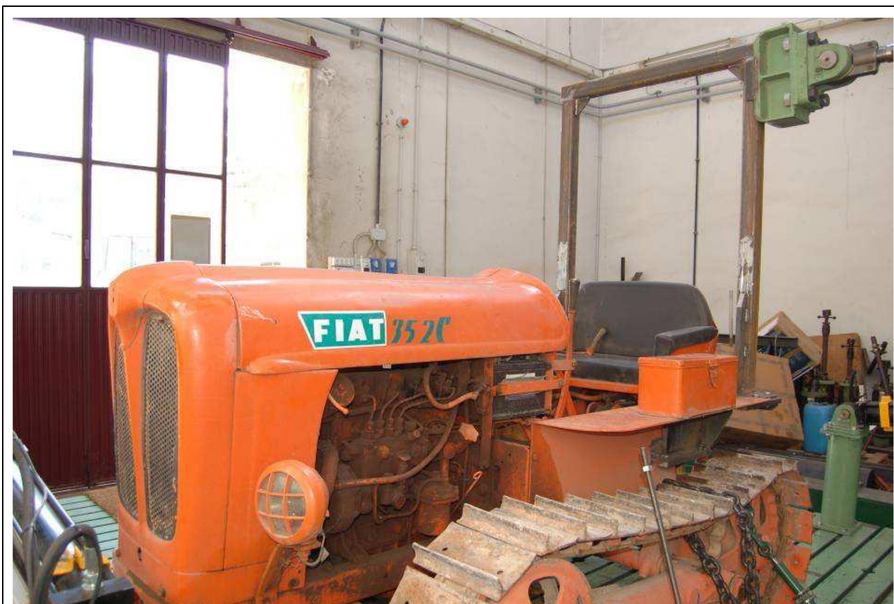
Figure 11 – Structure de protection pour tracteur à chenilles FIAT 352C
