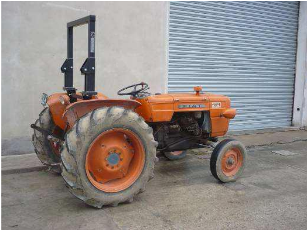
Figure 13. Structure de protection de type arceau arrière destiné à un tracteur à roue à voie standard de type FIAT 415R.
