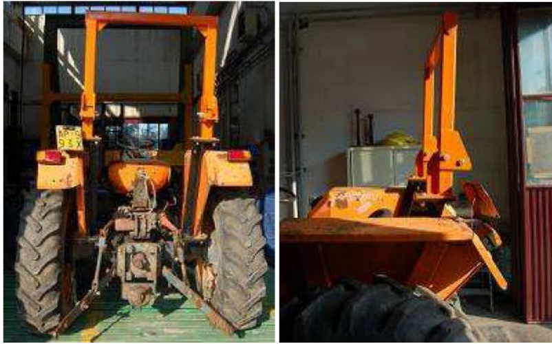
Figure 13. Structure de protection de type arceau arrière destiné à un tracteur à roue à voie standard de type FIAT 450 DTH.
