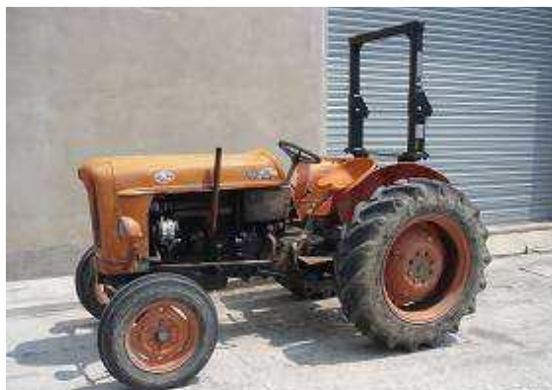
Figure 13. Structure de protection de type arceau arrière destiné à un tracteur à roue à voie standard de type FIAT 411R.
