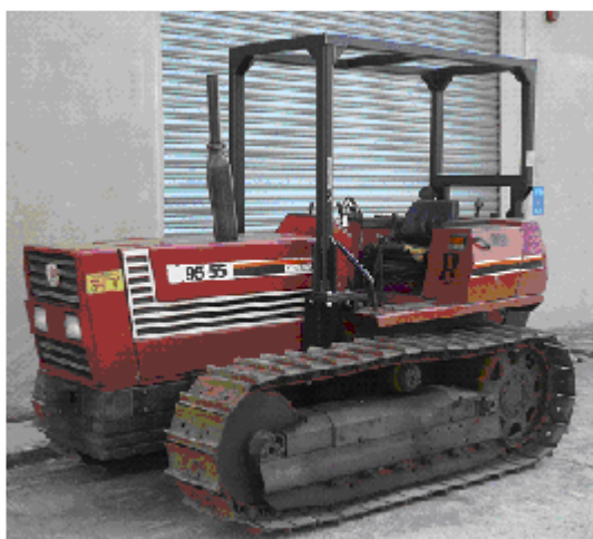
Figure 22 – Structure de protection pour tracteur à chenilles FIAT 955 et similaires
