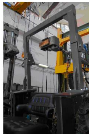
Figure 12. Structure de protection de type arceau arrière destiné à un tracteur à roue à voie standard de type FIAT 640.
