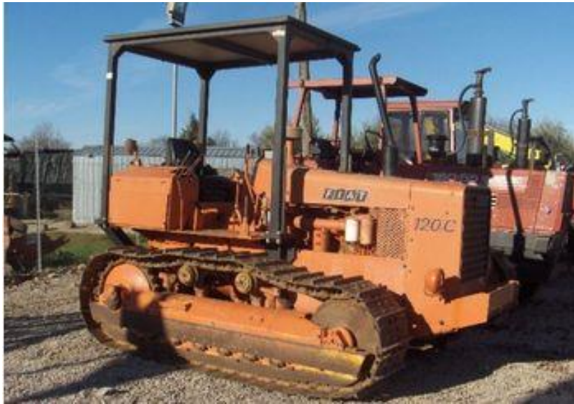
Figure 18 – Structure de protection pour tracteur à chenilles FIAT120C
