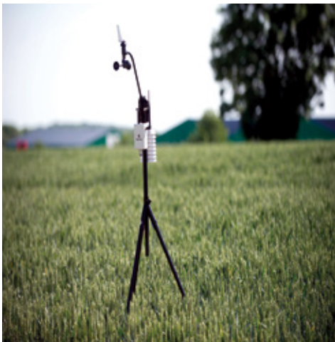
Station météo pour alimenter des outils de prévision de la pression parasitaire © agriculture.gouv.fr
