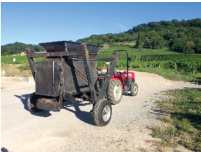
Épandeur à compost viticole conçu avec L'Atelier Paysan © Atelier paysan
