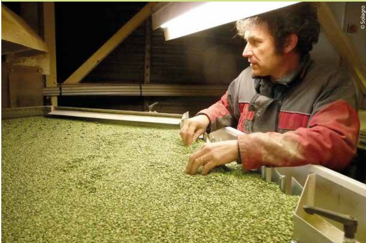
Triage de pois cassés à l'aide d'une table densimétrique.
