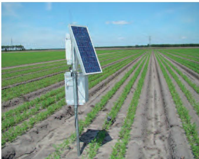
Sonde capacitive pour mesurer l'humidité du sol : pilotage fin d'irrigation - Gironde (France)
