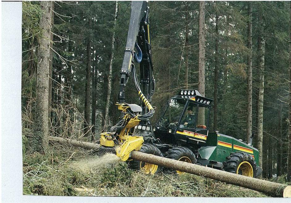
*Pendant la phase d'ébranchage, le débattement latéral du tronc est important et a lieu à une vitesse comprise entre 4 et 5 m par seconde. Il vaut mieux ne pas se trouver sur sa trajectoire !*
