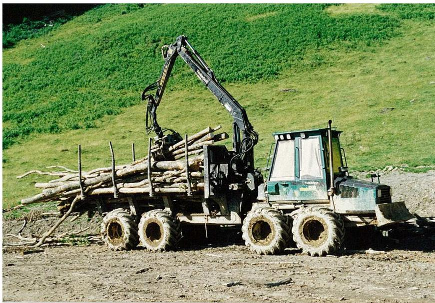
*Un des cas où la distance de sécurité doit être maximale : un gros porteur Timberjack avec grue de portée 10 m, manipulant des bois en toutes longueurs de 6 à 7m*
