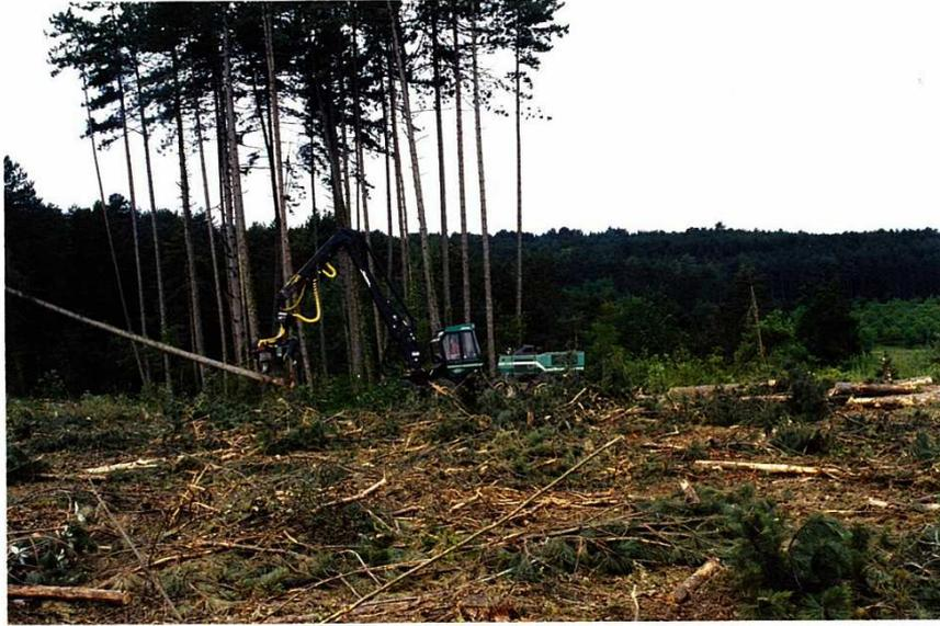
*Cette machine Silvatec mesure environ 8 m de long et sa grue a une portée de 10 m. Dans ces pins de plus de 25 m de hauteur, on voit bien la nécessité d'une distance minimale de l'ordre de 40 m*
