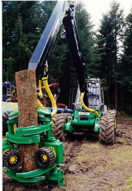
*Cette tête de bûcheronnage tient solidement l'arbre à abattre avec ses couteaux pinces et ses rouleaux à picots. En appuyant avec sa grue le conducteur va l'orienter vers l'avant.*
