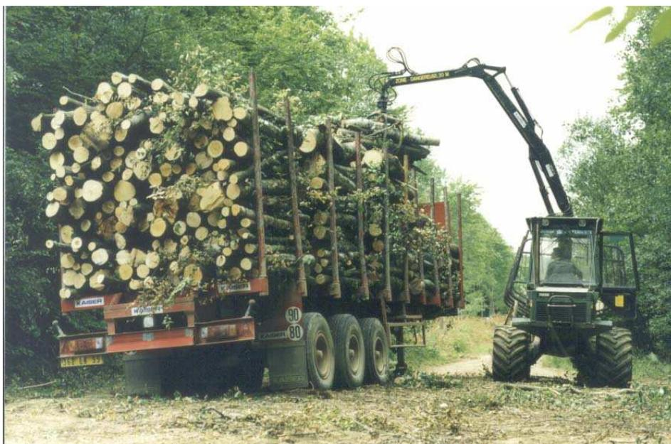
*Pour charger la semi remorque, ce petit porteur doit soulever ses grappins de billons au dessus des ranchers qui culminent à une hauteur de l'ordre de 3,50 à 4 m.*
