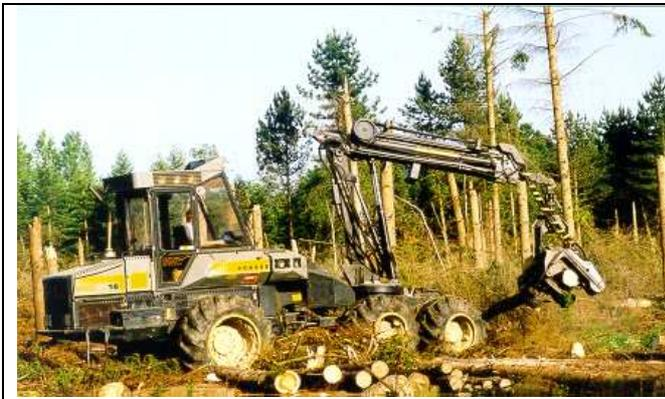
Une machine Ponsé en position d'ébranchage
