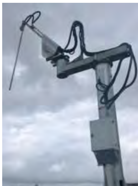
Figure 6 - Agréage : photographie d'une sonde de prélèvement
