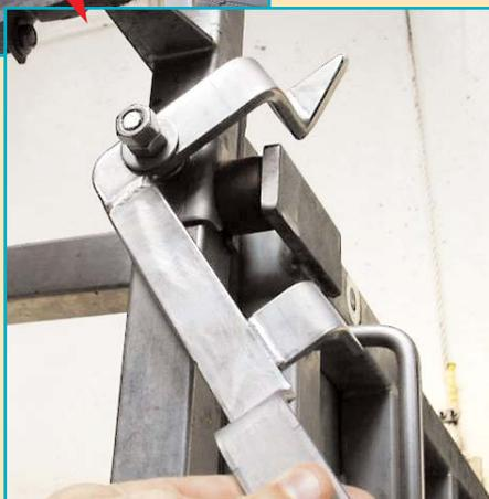
*... qui ne peut être actionné que par le trayeur, et à distance du pont. Cet équipement doit être complété par un jeu de miroir pour contrôler l'absence d'animaux, lorsque le trayeur passe de la laiterie à la fosse.*
