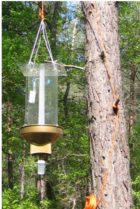
Figure 2 : photo et dessin du piège d'interception multidirectionnel vitré utilisé pour les captures des Monochamus en France. (Photo F.A. KOUTROUMPA).
