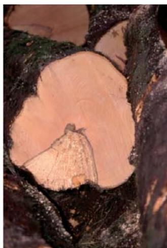
Dégradation typique du bois au départ de la lésion du cambium due au gel.
